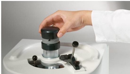
Слика 11. Млин са порцуланским сетом за млевење и системском интеграцијом
