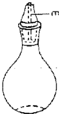
Слика 19: Пикнометар са капиларом m
