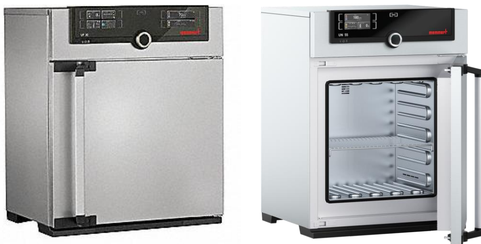
Слика 8. Пећ за сушење материјала
