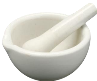
Слика 22. Аван са тучком за спрашивање материјала.
